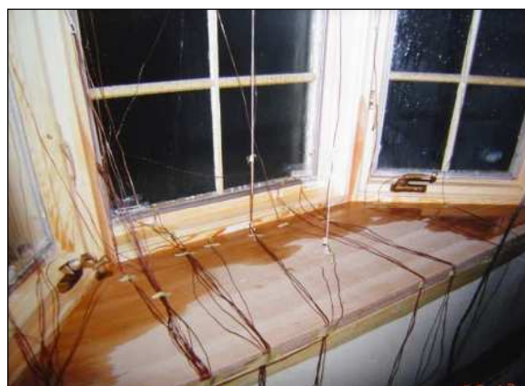
出窓の結露試験
