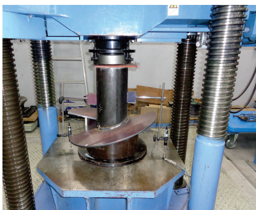
杭状地盤補強体の性能試験
