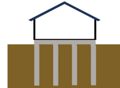
既存杭のリユース
