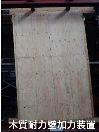
木質耐力壁加力装置 No.1, \gamma=67.1 \times 10^{-3} \text{rad}
