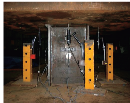
写真-1 520N/mm 2 鋼材及び550N/mm 2 鋼材の短柱圧縮試験の状況
