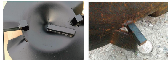
写真-1 翼部補強材
