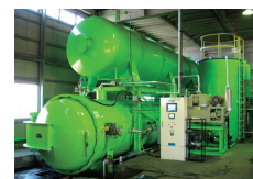
写真-4 加圧注入木材保存処理
