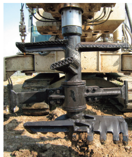
写真-1 SSコラム工法攪拌翼
