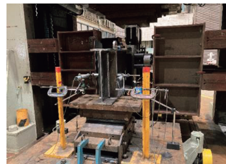
写真-2 520N/mm 2 鋼材及び550N/mm 2 鋼材の3点曲げ試験の状況
