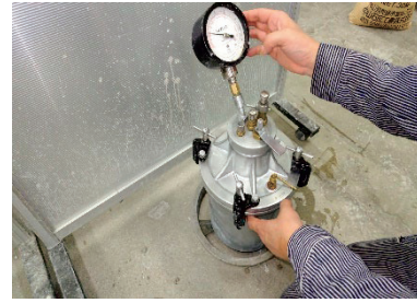
写真-1 実技試験 力量確認状況 (フレッシュコンクリートの空気量試験の場合)
