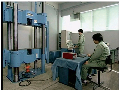
写真-1 校正状況 (一軸試験機)
