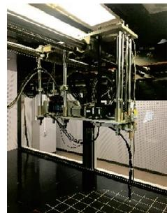
写真-7 トラバース装置
