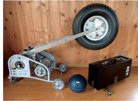
写真-1 床衝撃音試験の標準衝撃源
