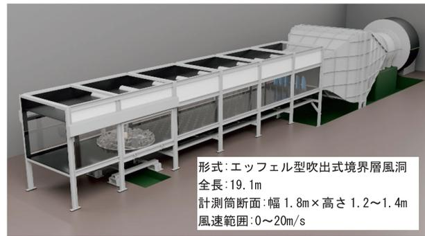
図-5 風洞装置の外観
