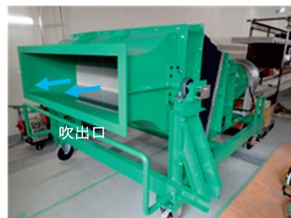
写真-5 屋根の飛火試験装置(送風機)
