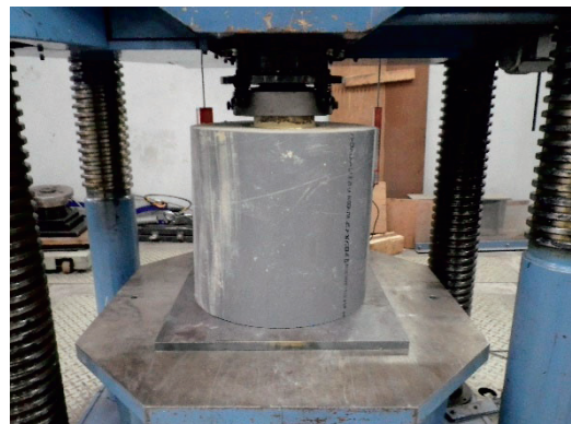
写真-11 地盤改良体の実大性能確認試験
