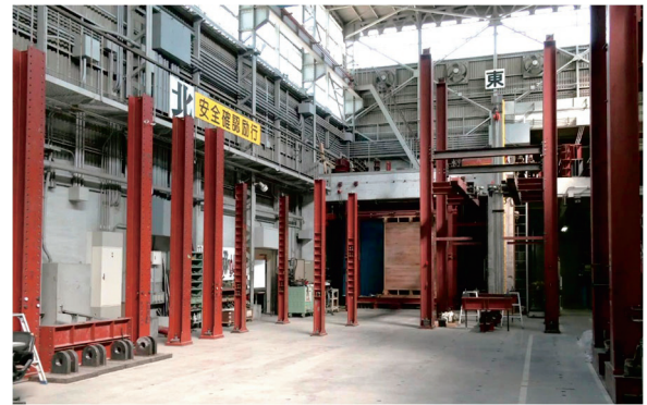
写真-1 補修工事後の載荷床
