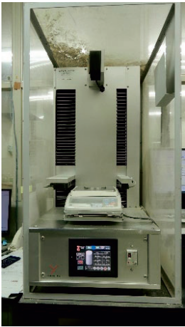
写真-9 供試体寸法質量 自動測定装置
