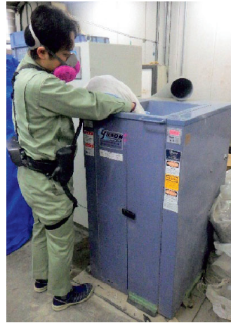
写真-10 大型多段振とう機 (パワーアシストスーツ を用いた道路用工事材 料の試料調整作業状況)
