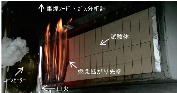
写真-3 縮小LIFT試験の実施状況
