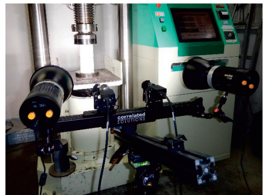
写真-1 非接触3Dひずみ計測システム (VIC)
