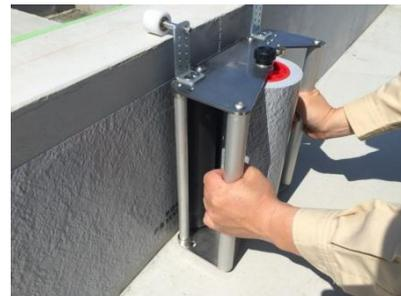
図-2 基礎高耐久化シート用施工道具
