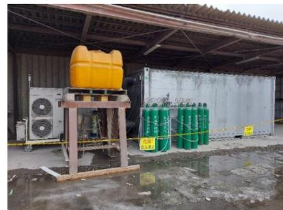
写真-1 炭酸化養生槽の例
