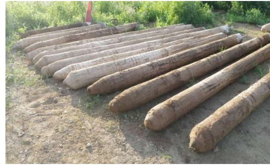
図 1 引き抜いた柱体の状況
